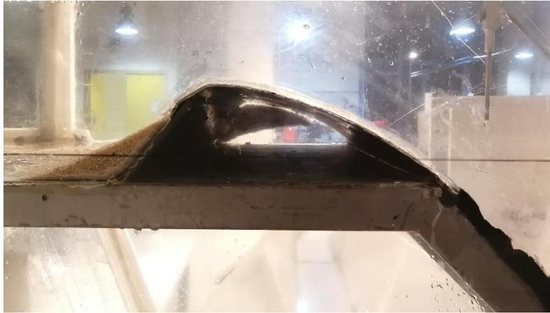
**Fotografía 2:** Perfil conopial tipo Ogee de la instalación experimental
