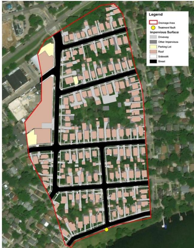
**Figura 11:** Distribución geométrica de áreas de fuentes impermeables que drenan a la bóveda de tratamiento de aguas pluviales con una pantalla de efecto Coanda y un sumidero en la cuenca de estudio
