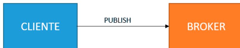
Figura 15. Esquema publicación MQTT Cliente-Broker
