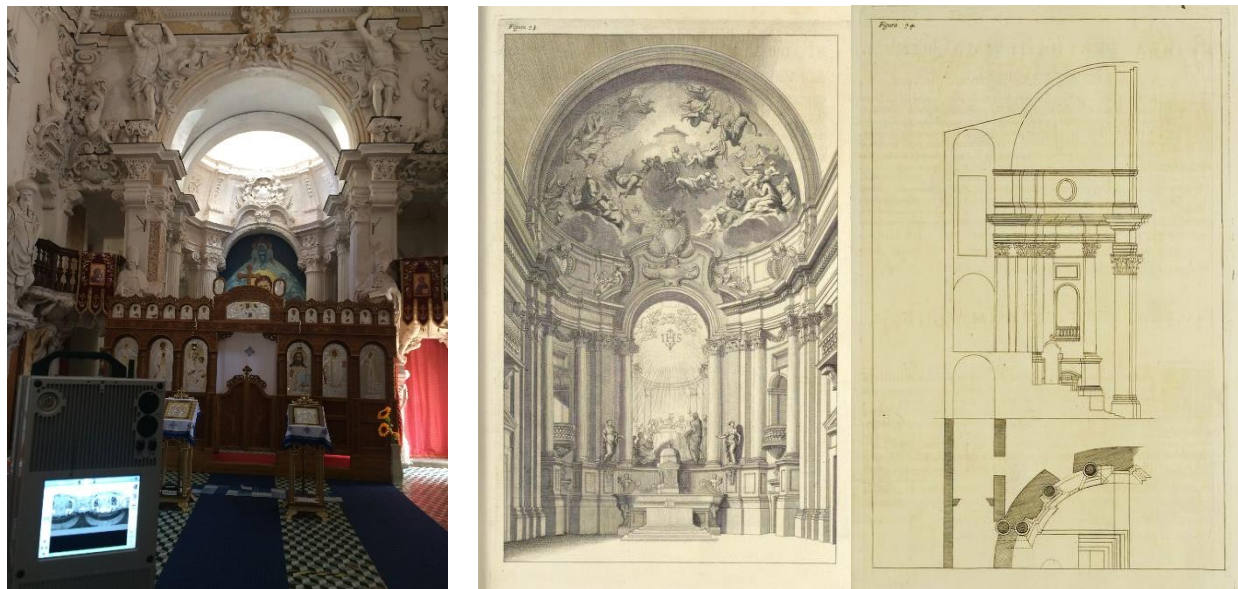
Figura 1. Trapani. Chiesa dell'Immacolatella, veduta verso la tribuna durante le operazioni di rilievo con scanner laser 3D a modulazione di fase Leica HDS7000 (foto M. Cannella, 2021, a sinistra); Pozzo, A., “Un altro Altare maggiore, per l'istesso luogo” e “Pianta e profilo del secondo disegno”, da Perspectiva pictorum et architectorum... , Roma 1700, II, figure 73-74 (Biblioteca del Dipartimento di Architettura di Palermo, ACR 102/2, a destra).
