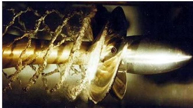
Figura 26: Efecto de cavitación de una hélice.
