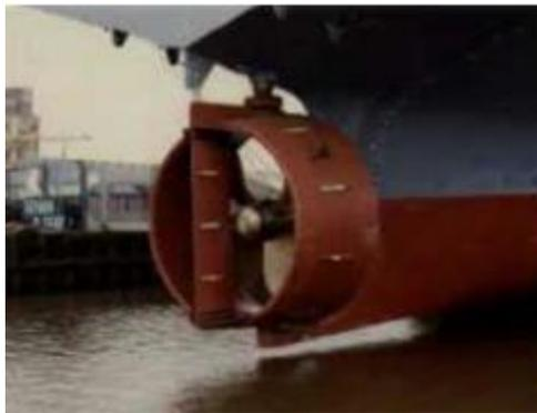
Figura 43: Hélice de conductos o de tobera.
