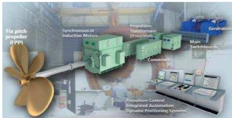
Figura 33: Planta de propulsión eléctrica.
