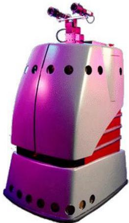
Figura 7. Robot MINERVA diseñado para guiado autónomo de visitantes a museos.
