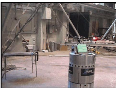
Figura 4. Robot autónomo AMELIA en una aplicación industrial de guiado visual de una viga sujeta por un elevador para acoplado sobre el extremo de otra viga fija.
