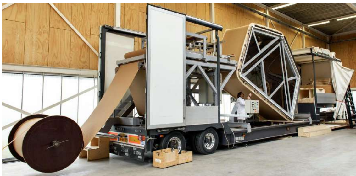
Figura 69: Imagen del proceso de la creación de la envolvente a base de capas de cartón. Autor: Yvonne Witte. Disponible en: https://www.fictionfactory.nl/en/wikkkelhouse/
