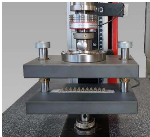
Figura 49: Imagen de ensayo CMT. Disponible en: https://www.zwickroell.com/es/sectores/papel-carton-y-papel-tisu/papel/ensayo-de-papel-corrugado-ensayo-cmt/
