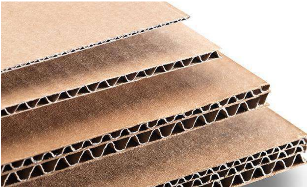
Figura 47: Planchas de cartón ondulado de diferente espesor. Disponible en: https://kartox.com/blog/las-diferentes-tipos-de-carton-ondulado/
