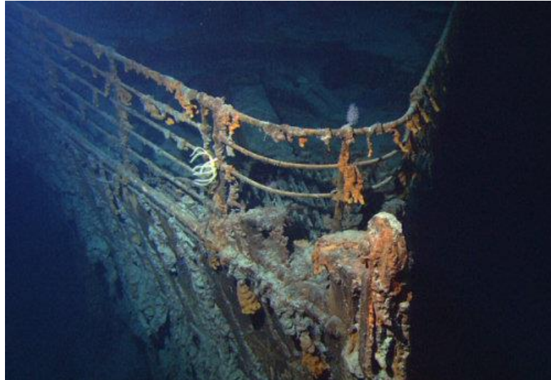
Figura 12. Corrosión microbiológica. Fuente: Jiménez-Ballesta, A.E. (s.f.), Selección de Materiales y Corrosión
