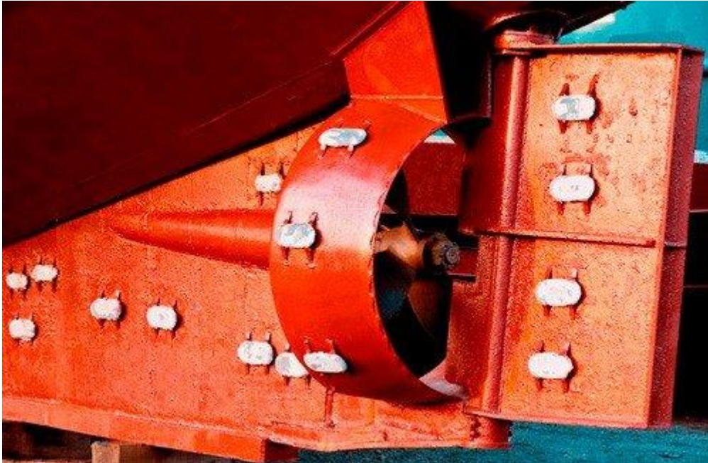
Figura 11. Protección del timón, la quilla y la tobera mediante ánodos de sacrificio. Fuente: https://www.electronicanautica.es/navegacion/anodos-para-barcos-para-que-sirven
