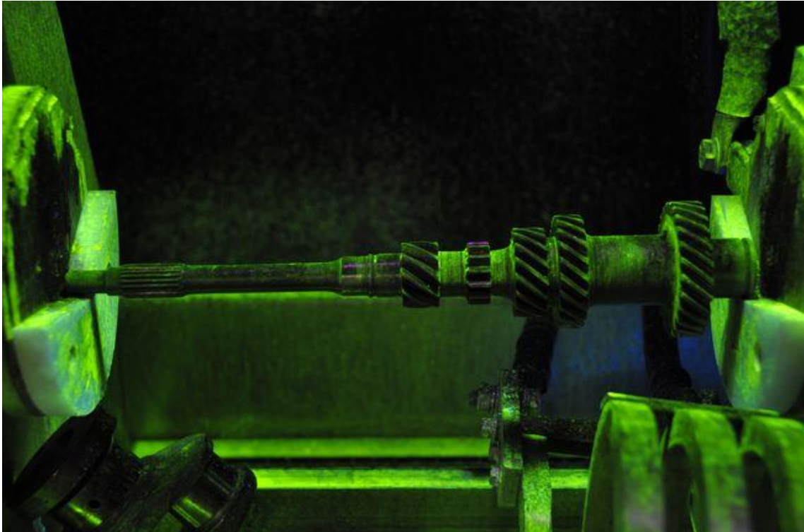
Figura 9. Detección de grietas y fisuras en el engranaje mediante el procedimiento de partículas magnéticas. Fuente: https://www.tuv-nord.com/es/es/formacion/ensayos-no-destructivos/particulas-magneticas/curso-mt-nivel-2-directo/
