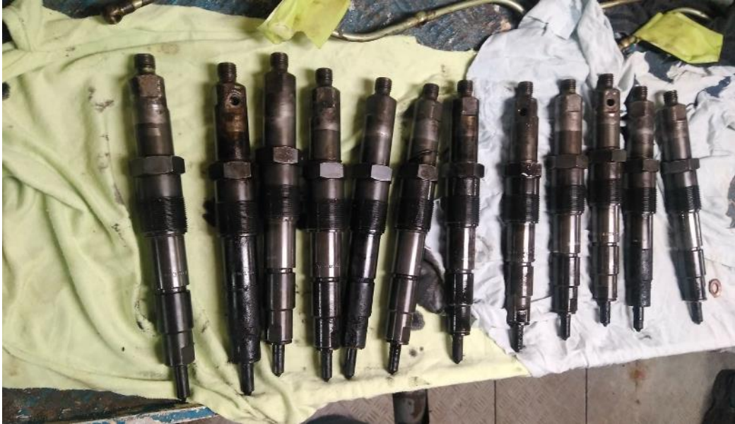
Figura 31. Inyectores en mal estado. Fuente: Miguel Ángel Campos
