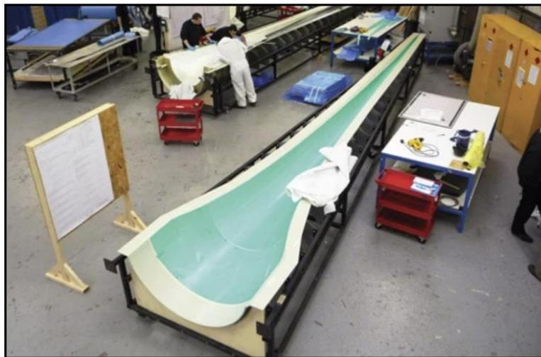
Figura 3.66. Fabricación de las palas de la turbina HS1000. Fuente: empresa *Gurit*.
