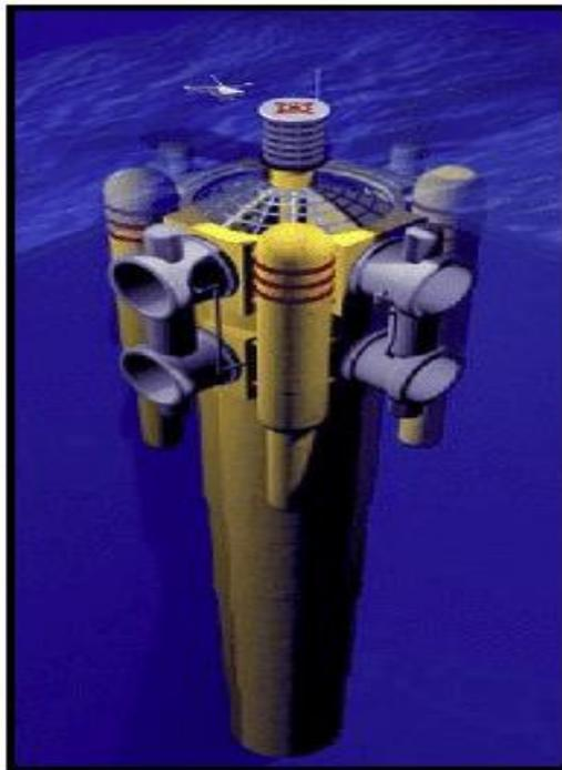
Figura 2.7. Dispositivo tipo OTEC de ciclo Rankine.
