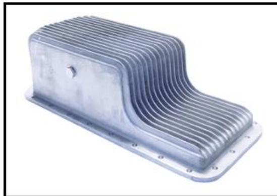
Figura 3.38. Carter con palas en su carcasa para disipar calor. Fuente “*ingeniero marino*”.
