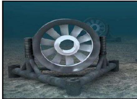
Figura 2.27. Dispositivo *Open-Centre Turbine*. Fuente: empresa *OpenHydro*.
