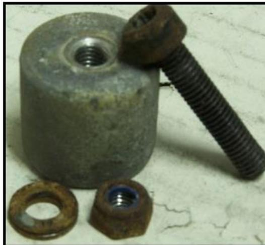
Figura 3.13. Elementos de unión usados en la construcción naval offshore. Fuente: empresa *Zineti S.A.U.*
