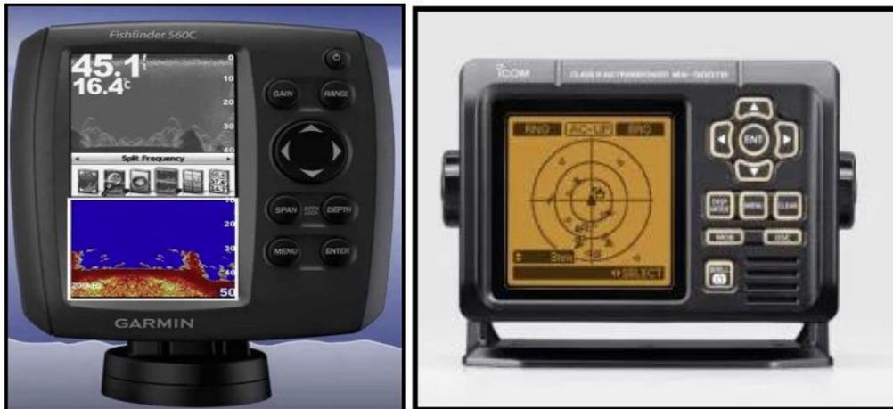
Figura 3.59. A la izquierda: dispositivo sonar de detección de mamíferos. A la derecha: sistema AIS de localización del artefacto. Ambos sistemas ubicados en el centro del control.
