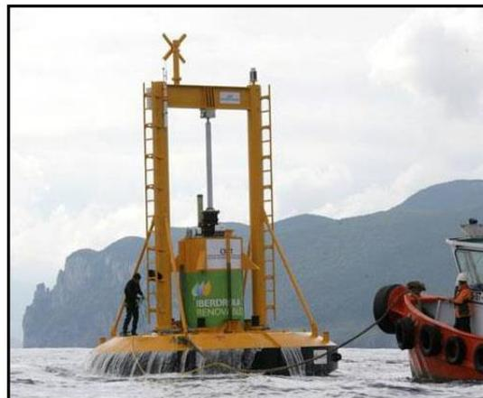
Figura 2.2. Sistema de captación de energía undimotriz de Santoña. Fuente: *IBERDROLA*.
