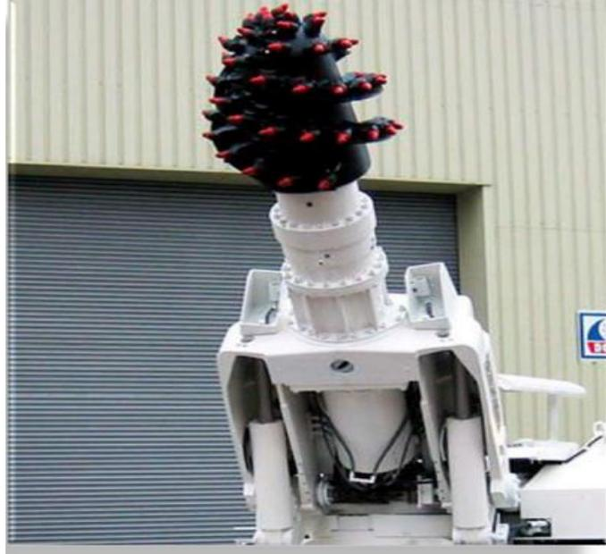
*Imagen 13. Rozadora cabeza de corte longitudinal.*
