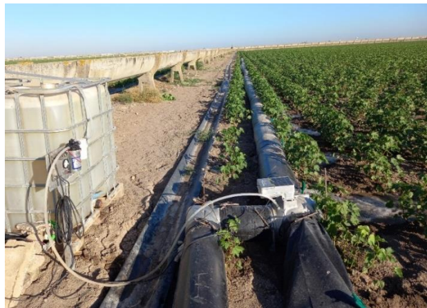
Figura 3. Imagen del sistema en funcionamiento con el sistema de fertirrigación incorporado.
