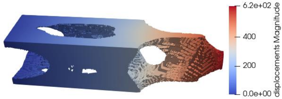
Figura 5.21 Desplazamientos voladizo 3D, malla desestructurada
