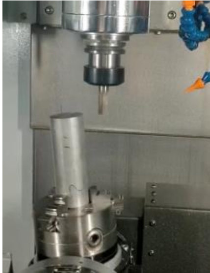
Figura 8. 6. Prueba de mecanizado del nodo inferior
