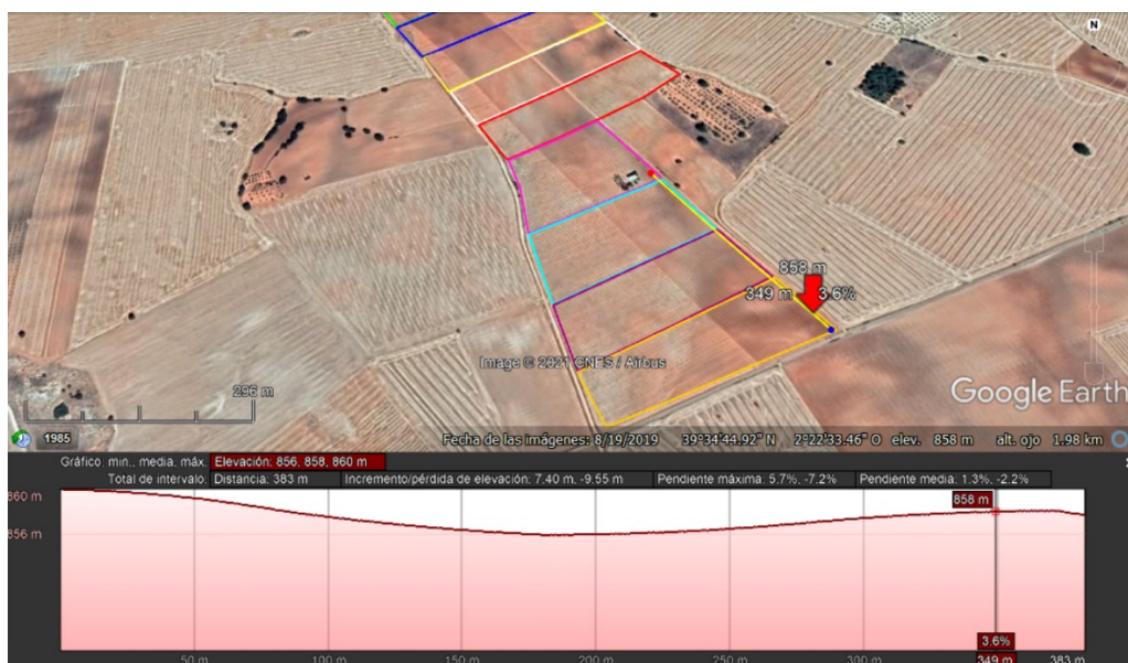
Ilustración III-3. Perfil topográfico del desnivel y alturas desde pozo hasta punto más lejano de riego hacia el Sur de la finca. Google Earth.
