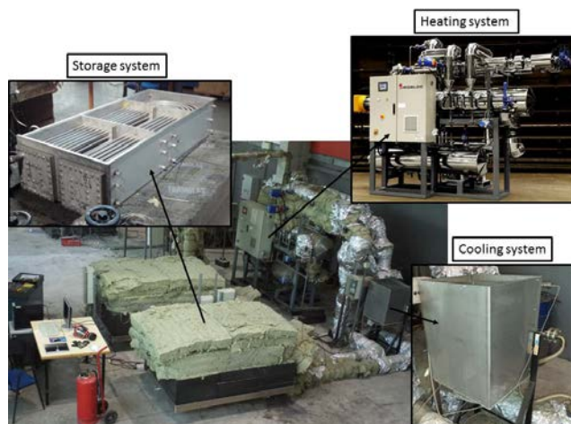
Figura 10. Instalación de la planta piloto de alta temperatura de la Universitat de Lleida
