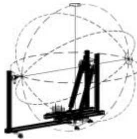
Figura 2.7: Esquema de la configuración esférica (Keysight and NSI, 2004)
