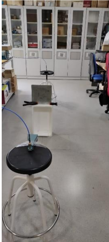
Figura 6.14: Fotografías de las medidas realizadas para el Reflect mediante una placa de metal colocada entre las 2 antenas.
