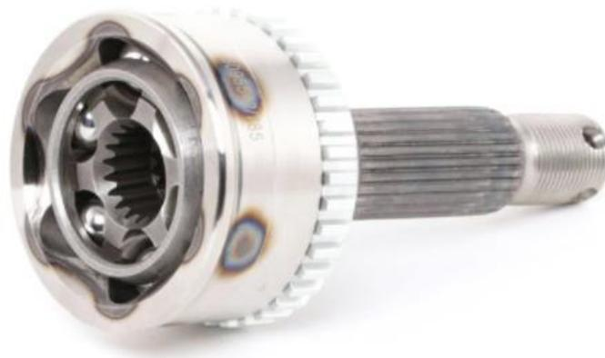
Figura 3.38 Junta homocinética o junta de transmisión empleada por el equipo en años anteriores.
