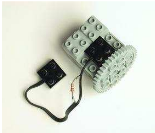
Figura 2.5. Imagen de un motor DC del RCX modificado para funcionar como sensor de velocidad angular.
