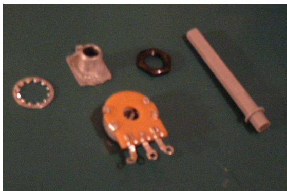
Figura 5.8. Imagen del potenciómetro desmontado. Las pletinas y la pista resistiva aparecen unidas.
