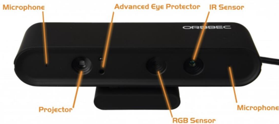
Figura 24. Componentes de la Orbbec Astra Pro, según ROS Components.
