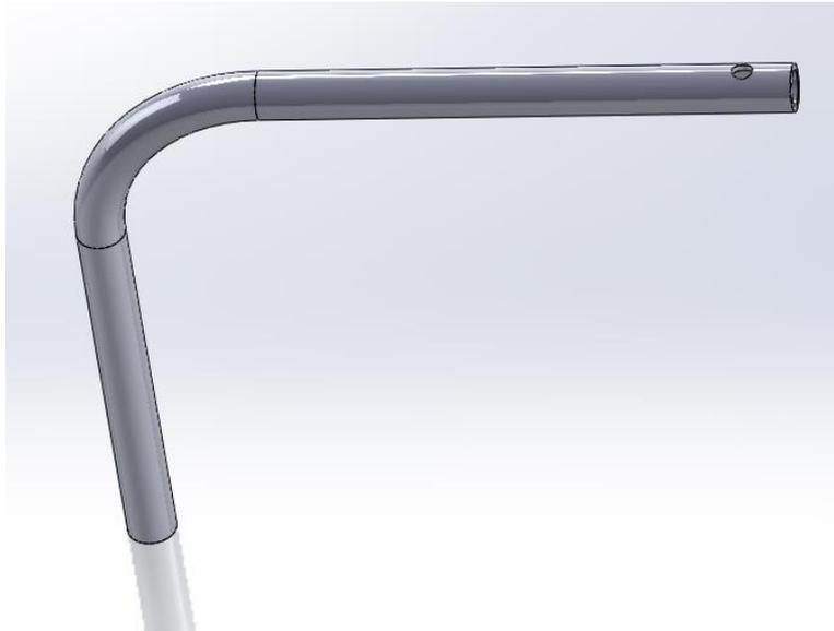
Figura 67. Diseño de la barra del pescante de la boca de hombre en SolidWorks.
