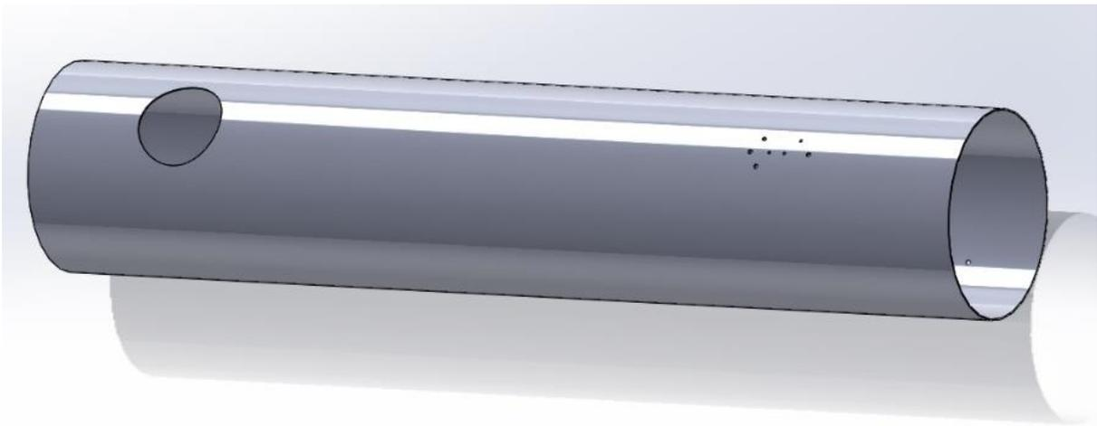
Figura 40. Diseño de la virola con aberturas en SolidWorks.
