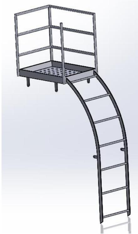
Figura 50. Diseño de las escaleras en SolidWorks.
