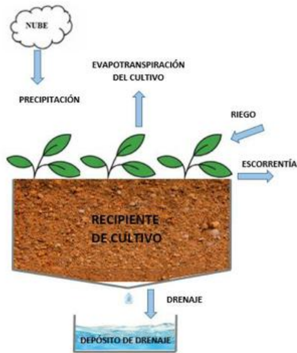
Figura 1. Diagrama de entradas y salidas de agua del recipiente de cultivo y el depósito de drenaje del lisímetro de pesada.
