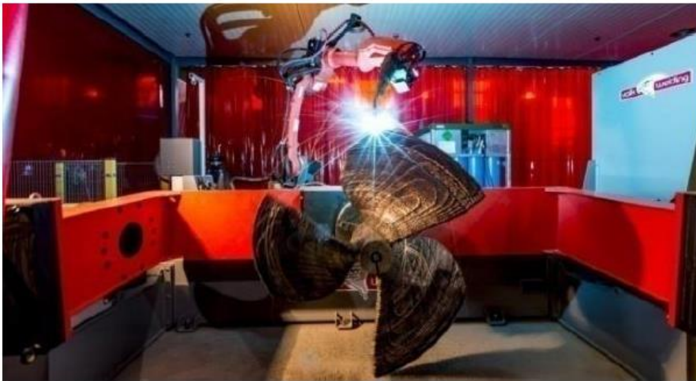
Ilustración 43: Proceso de fabricación de la helice WAAMPeller. Fuente: damen.com
