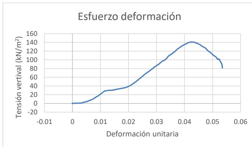
Gráfica 4.2 Curva esfuerzo-deformación vertical. Muestra 1
