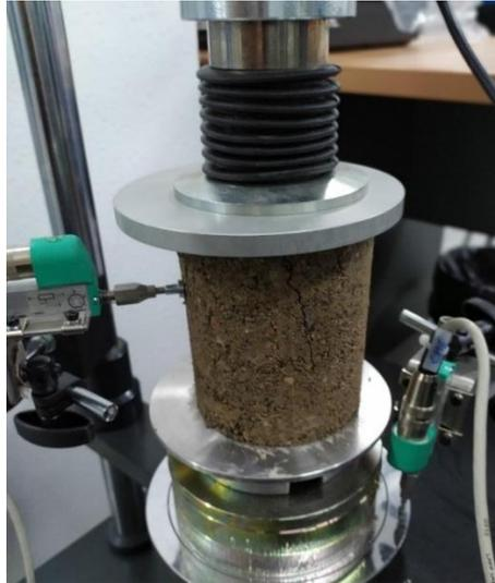
Figura 4.8 Instalación de los Deformímetros.
