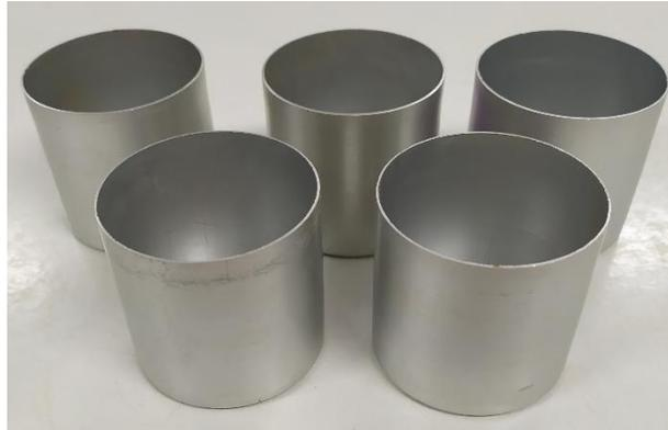
Figura 4.14 Recipientes metálicos para la determinación de la humedad.
