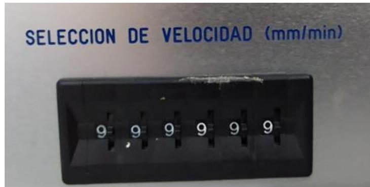
Figura 3.2 Máxima velocidad del equipo de compresión simple.
