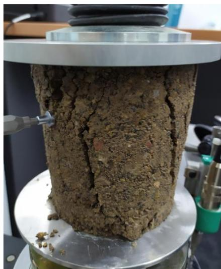
Figura 4.11 Rotura de la Muestra 1
