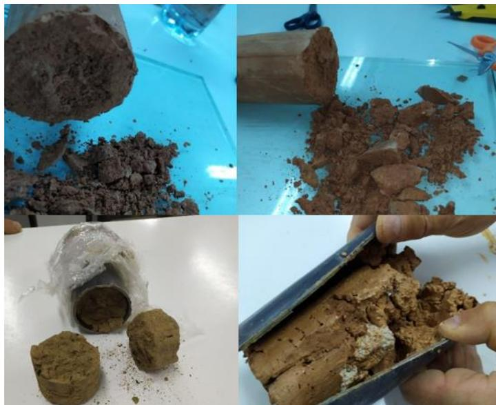
Figura 4.2 Muestras fallidas de sondeos geotécnicos.
