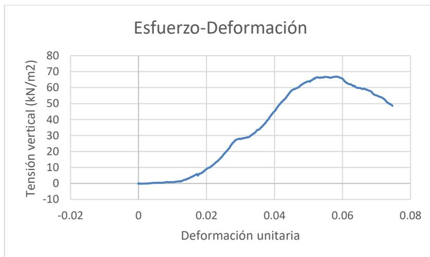
Gráfica 4.4 Curva esfuerzo-deformación vertical. Muestra 2
