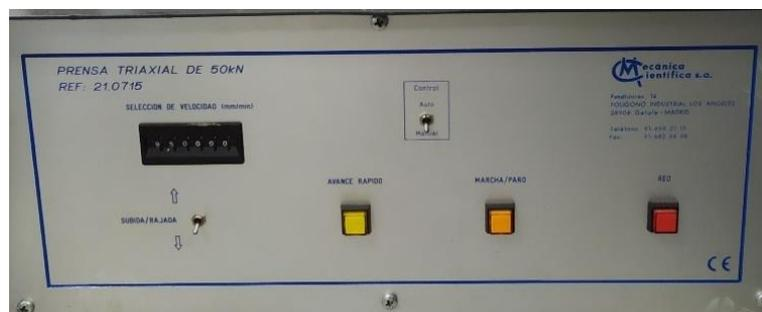
Figura 3.1 Comando de mandos del equipo de compresión simple.
