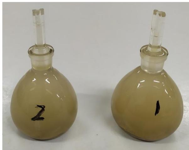
Figura 4.18 Picnómetro con muestra y agua.
