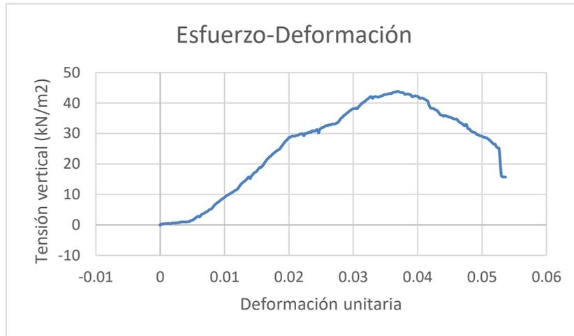
Gráfica 4.8 Curva esfuerzo-deformación vertical. Muestra 4
