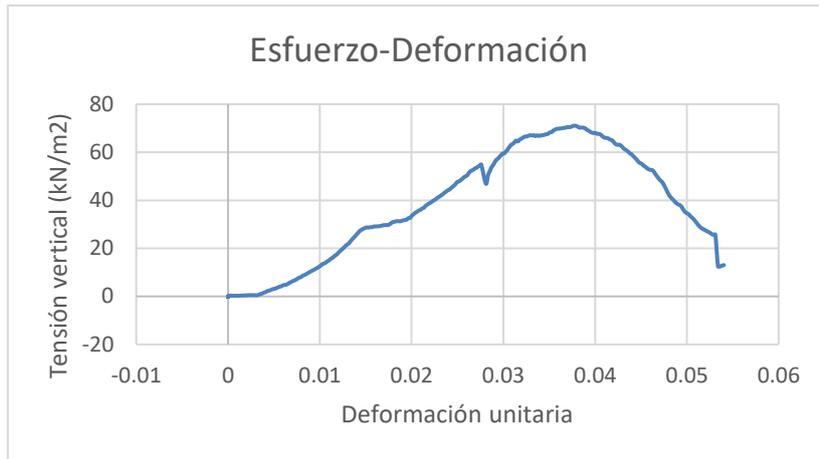
Gráfica 4.10 Curva esfuerzo-deformación vertical. Muestra 5
