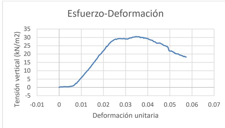
Gráfica 4.6 Curva esfuerzo-deformación vertical. Muestra 3
