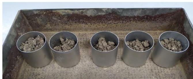
Figura 4.15 Recipientes metálicos con muestra seca.
