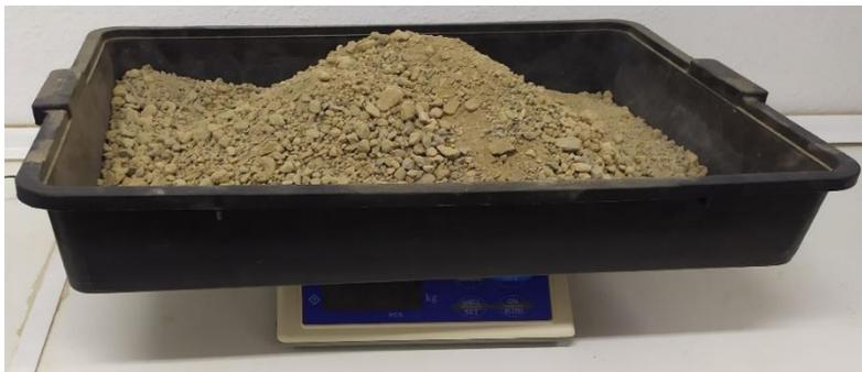
Figura 4.4 Determinación de la masa para ensayo Proctor.
