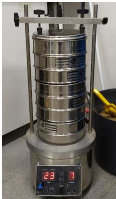
Figura 4.1 Tamizado de la muestra de suelo.
