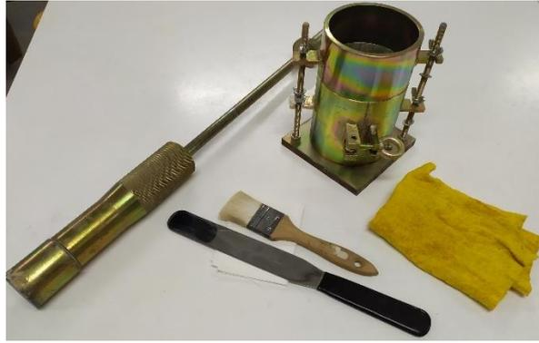
Figura 4.3 Material para el ensayo Proctor.
