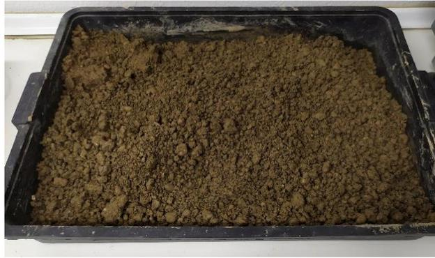
Figura 4.5 Amasado de la muestra. Ensayo Proctor
