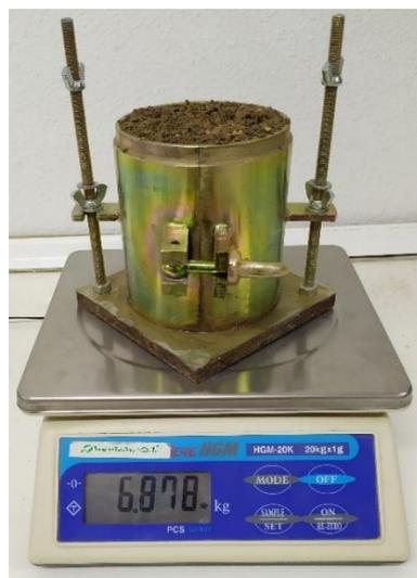
Figura 4.6 Determinación de la masa del molde Proctor.
