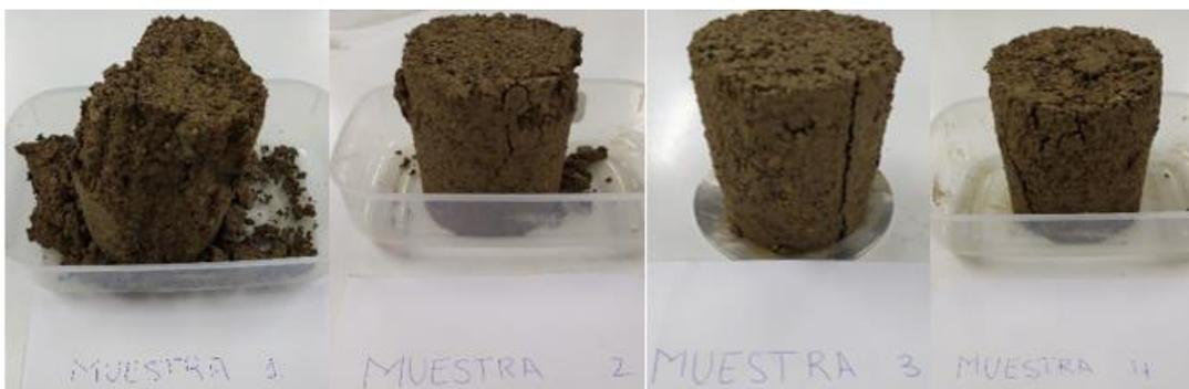
Figura 4.13 Muestras después del ensayo de compresión (falta la muestra 5)
