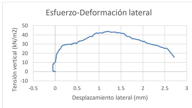
Gráfica 4.9 Curva esfuerzo-deformación lateral. Muestra 4
