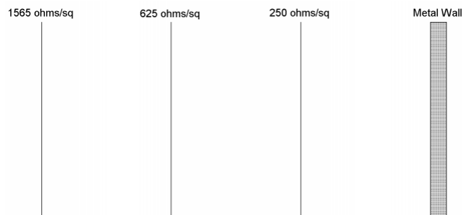
Figura 11: «Jaumann Sandwich». Fuente: Dash, Glen and Llc. Ampyx, How RF Anechoic Chambers Work
