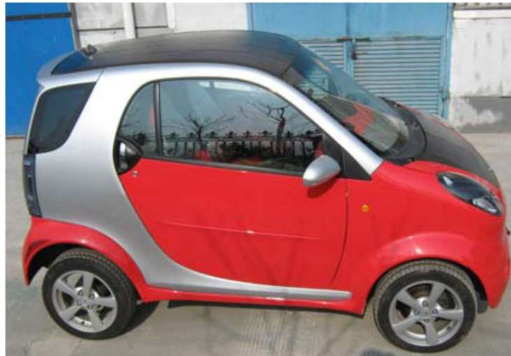
Figura 3. Shuanghuan Noble con módulos fotovoltaicos en su superficie [9].
