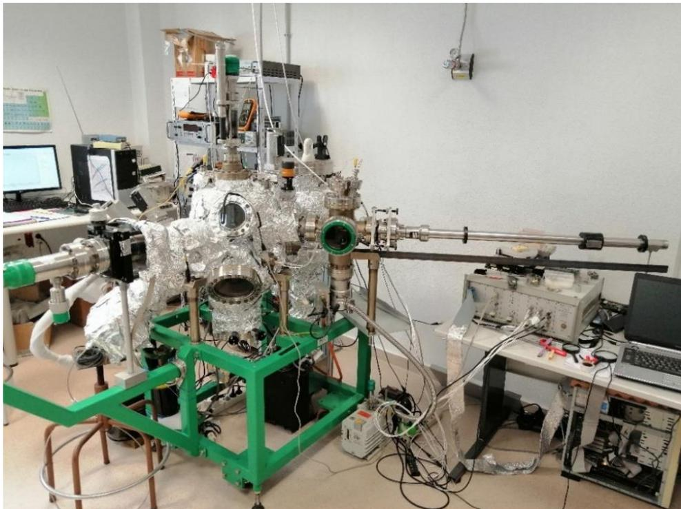
*Figura 1.1. Equipo experimental. Campana de ultra alto vacío y otros dispositivos*
