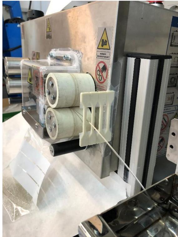
Figura 33: Introducción del hilo de PLA a la peletizadora
