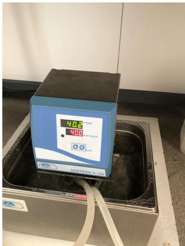
Figura 26: Sistema de recirculación
