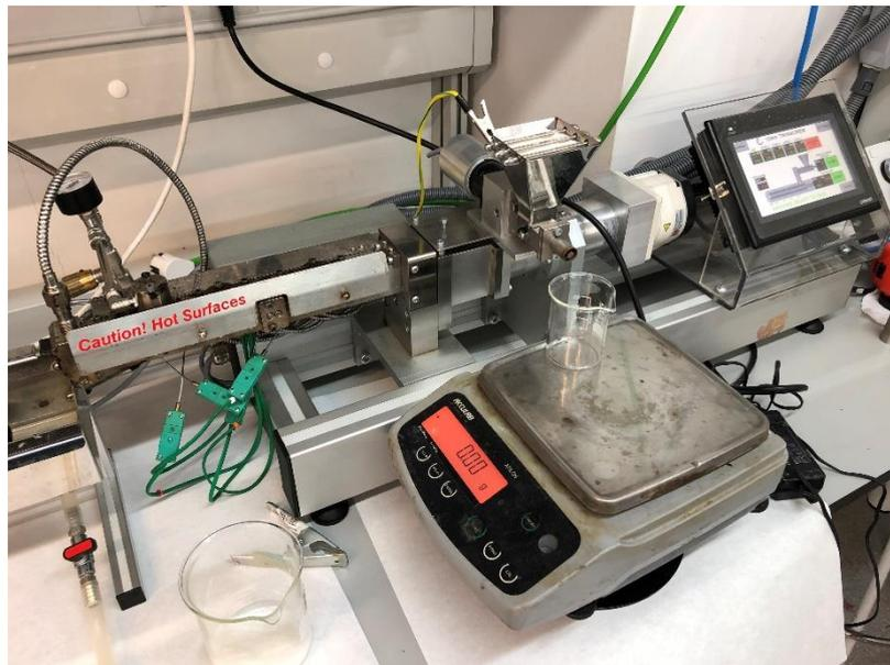
Figura 31: Método empleado para determinar el caudal de alimentación
