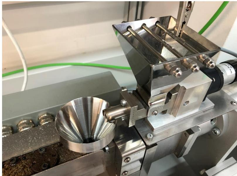
Figura 22: Sistema "starve feed" montado sobre la extrusora
