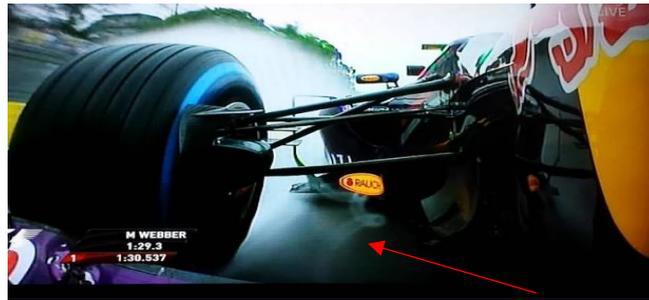
Figura 7. 9. Vórtice generado por alerón delantero.
