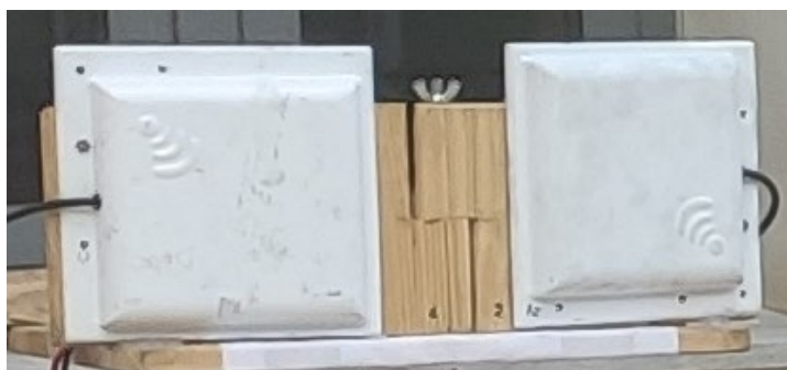
Figura 11 Antenas Direccionales de Panel
