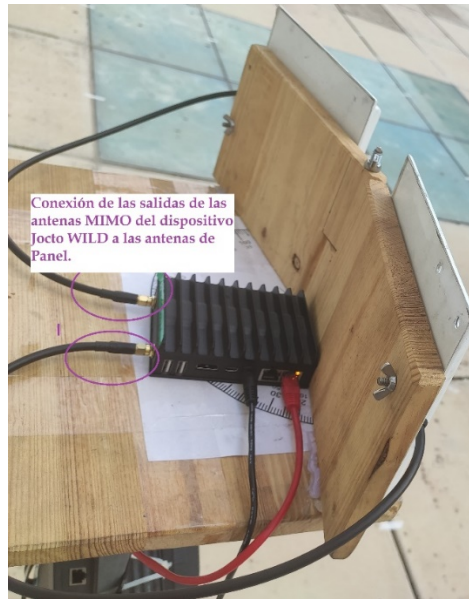
Figura 12 Conexión de Jocto WILD con array de antenas
