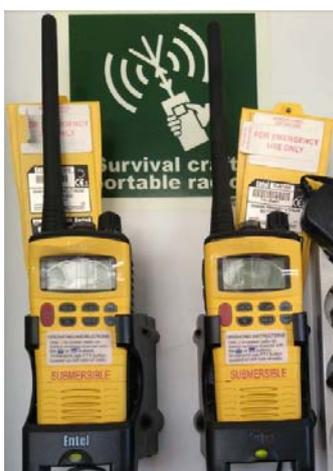
Ilustración 5.1. Aparatos radioeléctricos bidireccionales de ondas métricas.
