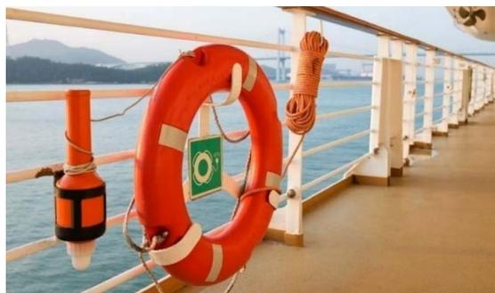
Ilustración 5.2. Aro salvavidas con señal luminosa y rabiza flotante.
