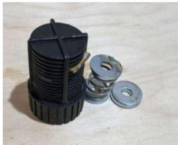
Figura 3.10 – Piezas del modelo inicial III (Válvula de ariete)
