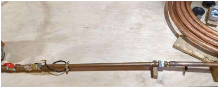
Figura 3.15 - Tramo de enlace entre la espiral y la bomba
