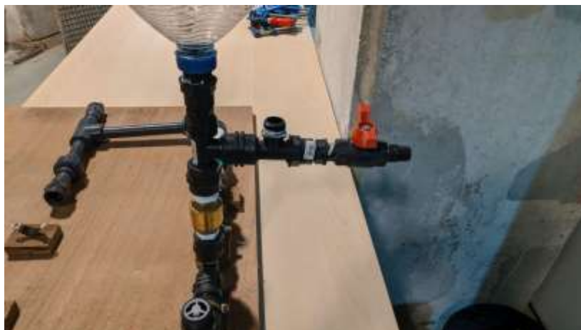
Figura 3.3 – Bomba de ariete de PVC I
