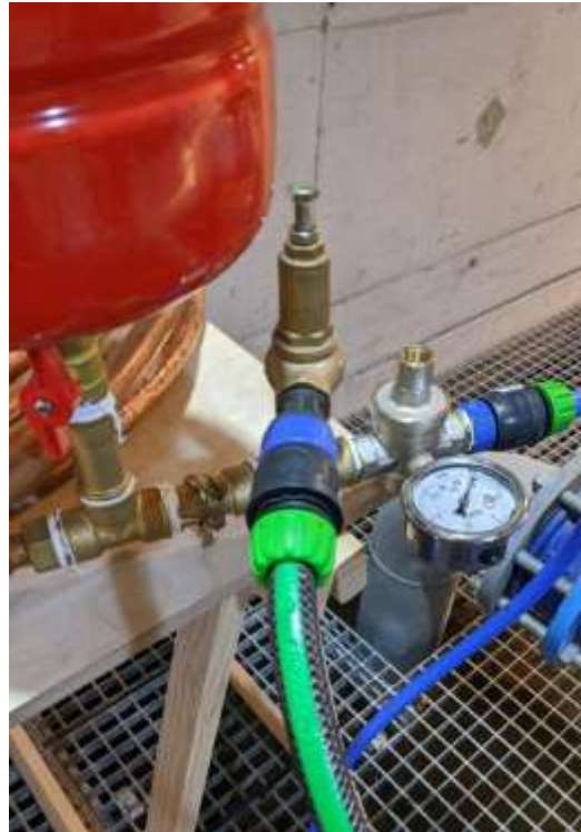
Figura 3.16 – Elementos para ajustar la presión de aspiración
