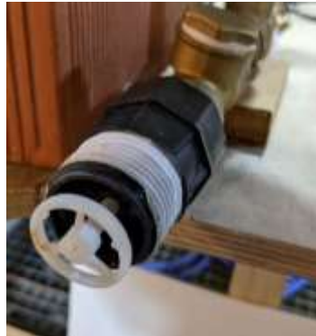
Figura 3.18 – Válvula de ariete cerrada
