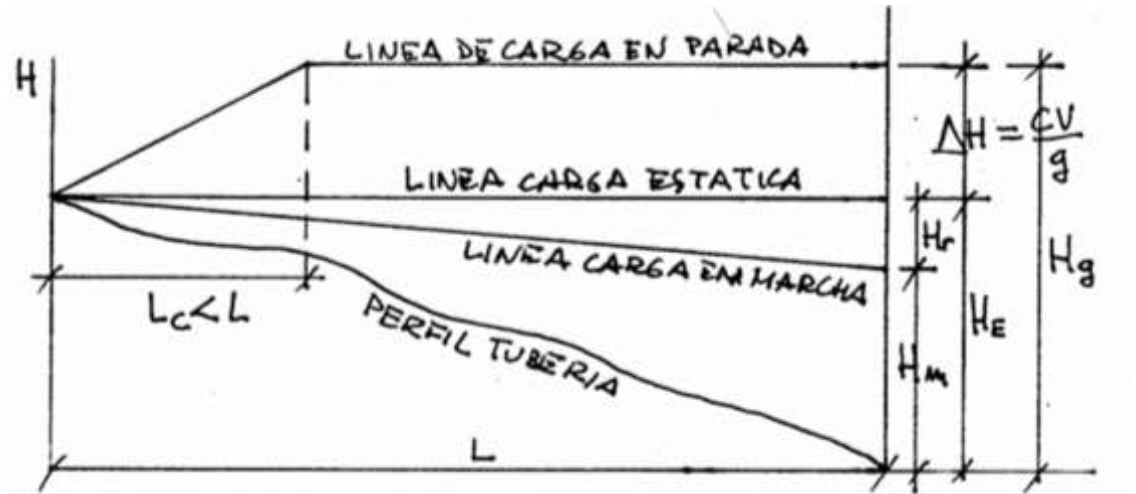
Figura 2.2 - Cierre rápido en instalaciones a gravedad
