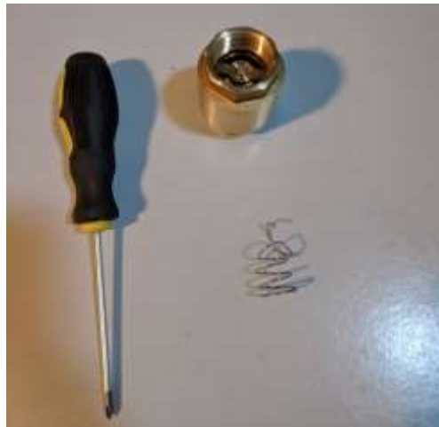
Figura 3.13 - Válvula antirretorno modificada
