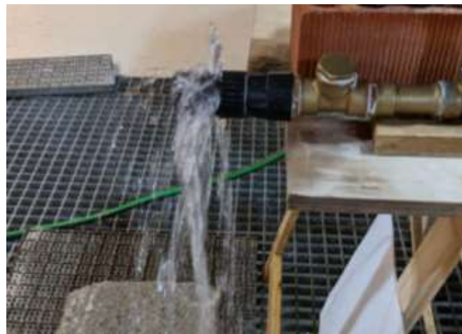
Figura 3.19 – Válvula de ariete abierta ( Q_t )
