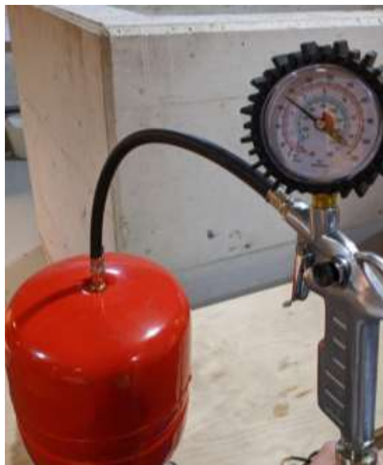
Figura 3.17 – Ajuste en la presión del calderín
