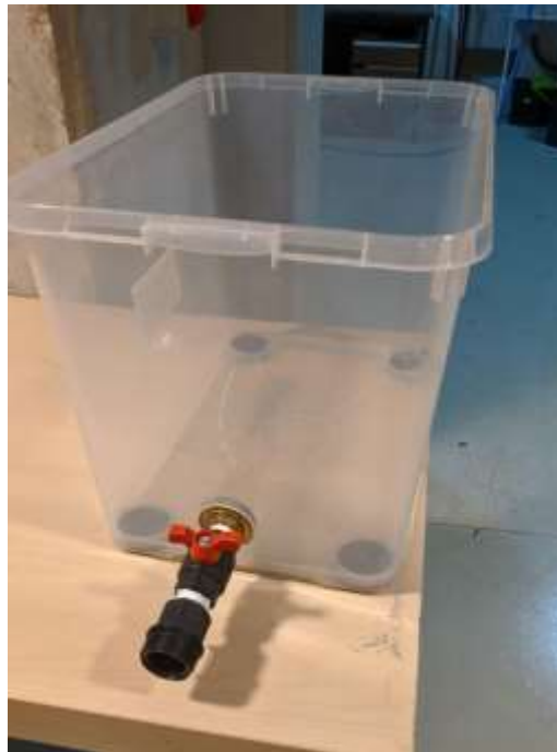
Figura 3.7 – Depósito inicial de aspiración
