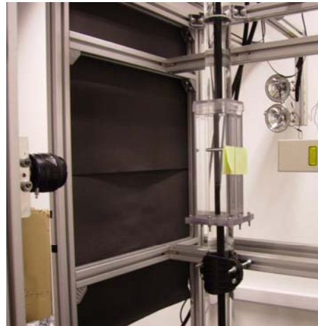
Fig. 3 Fotografía del sistema de PIV
