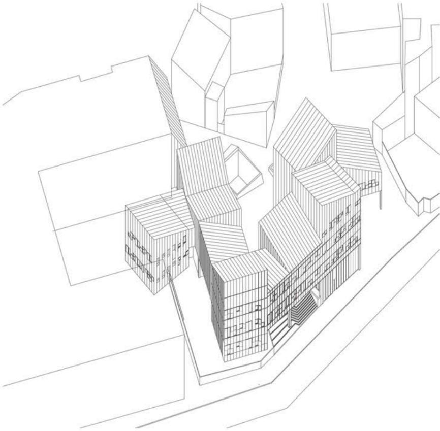
La planta 1 se compone de 9 módulos más 3 de conexiones. La volumetría del edificio surge a partir de la planta 1, prolongando hacia abajo y hacia arriba algunos de los módulos que la componen. Obtenemos, así, 4 módulos en planta baja, 4 en la planta segunda y 2 en la tercera.
