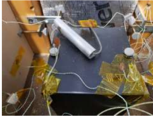
Figura 6. Termopares en el interior.
