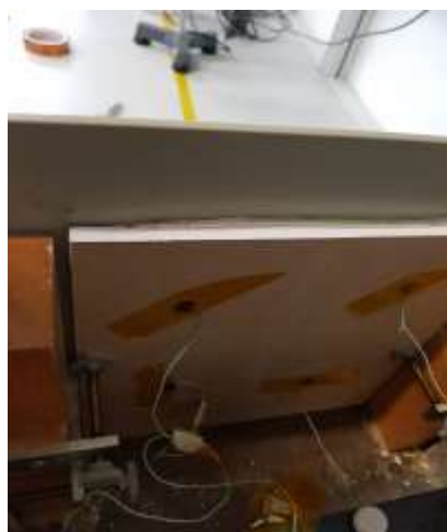
Figura 5. Termopares en interior de pared principal.
