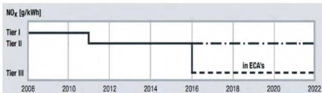
Figura 3 Diagrama de años de cumplimiento de la normativa MARPOL de emisiones Fuente: Convenio MARPOL
