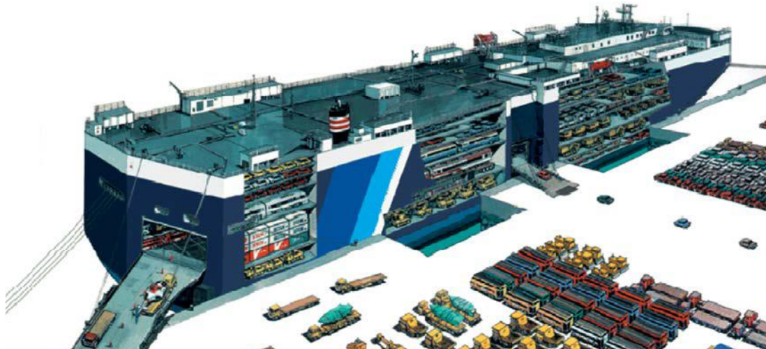
Figura 10 Disposición estructural de los buques Ro-Ro Fuente: Exponav.org
