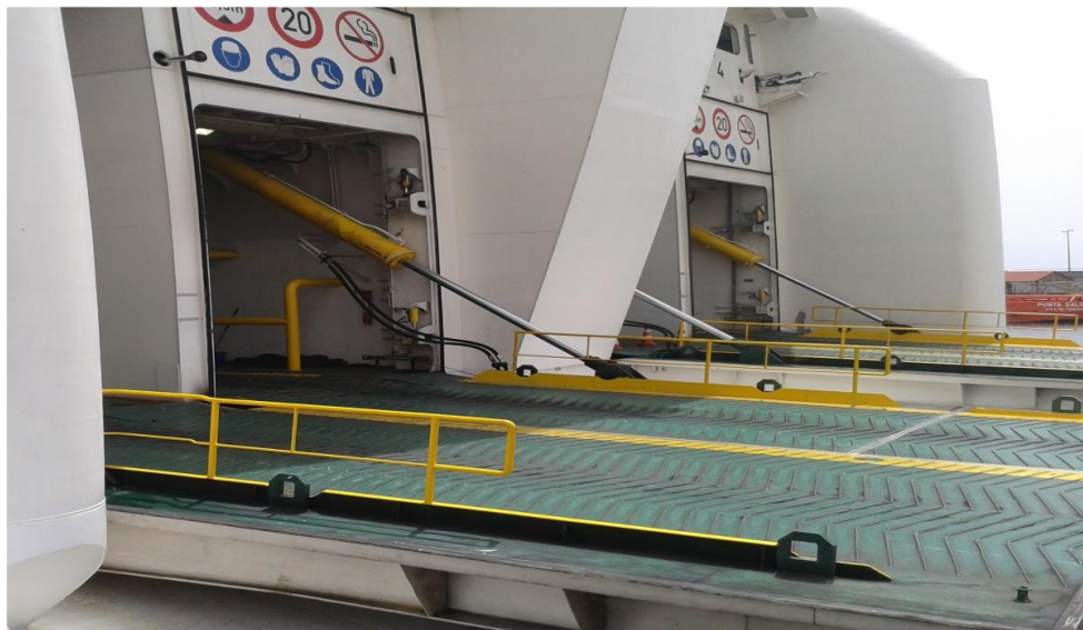
Figura 12 Rampas de buques Ro-Ro Fuente: Naviera Armas
