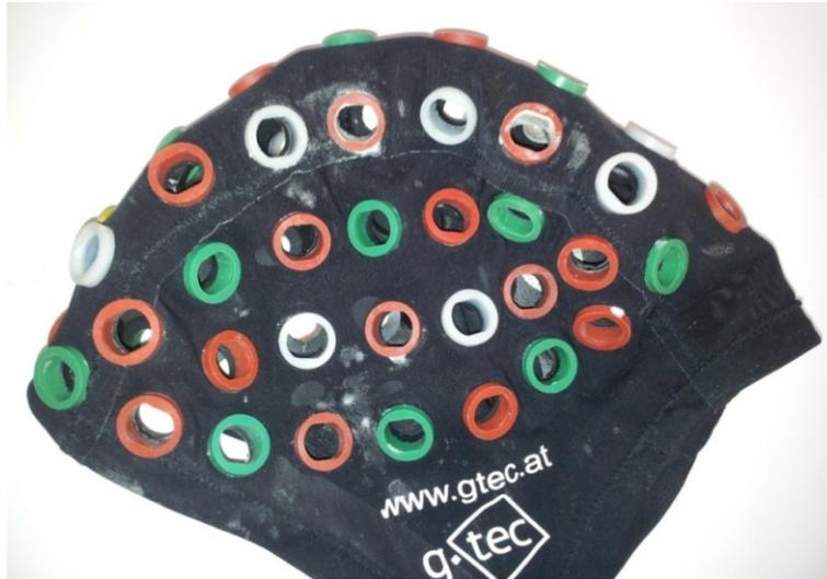
Figura 4.8.2: Casco gEEGcap para la inserción de electrodos de la firma Gtec según el sistema estándar 10/20.
