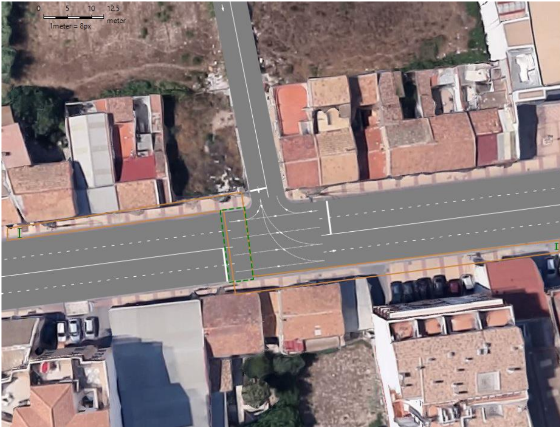
Ilustración 64. Representación gráfica del modelo de la intersección n°2 en AnyLogic. Fuente: Elaboración propia.
