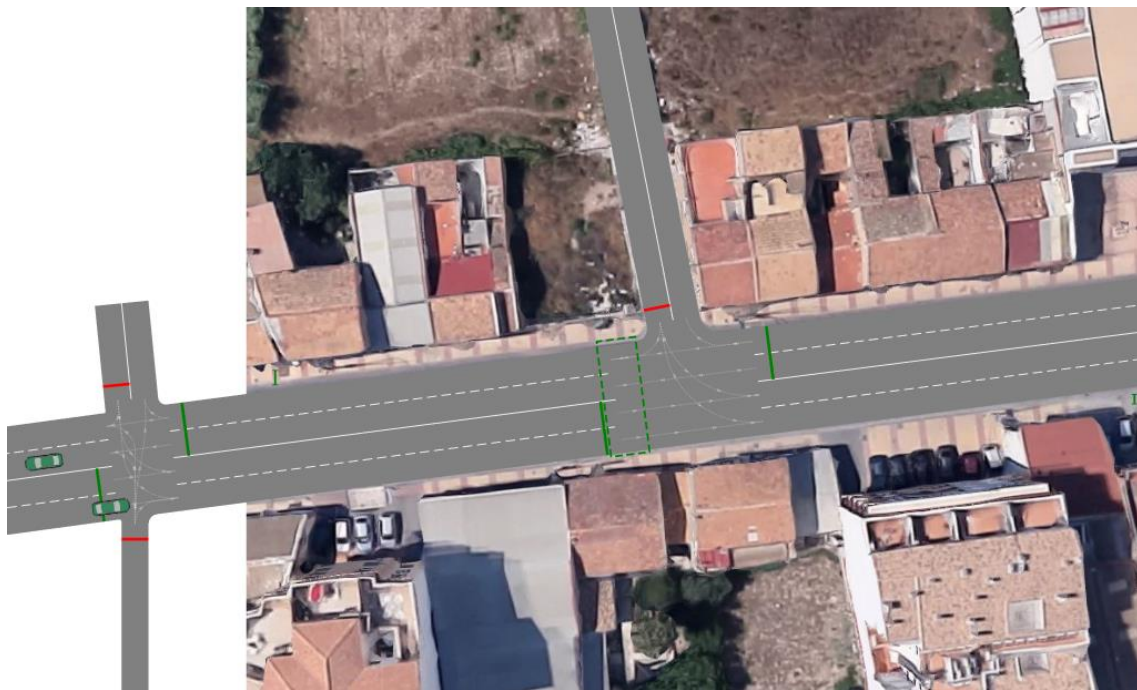
Ilustración 67. Representación gráfica del modelo de la intersección n°2 con intersección adicional en AnyLogic. Fuente: Elaboración propia.
