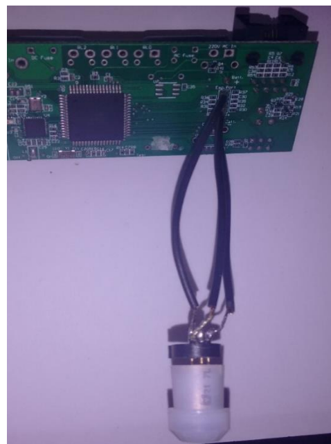
Figura 4.7: Puertos auxiliares e interfaz auxiliar para el sensor de movimiento analógico.
