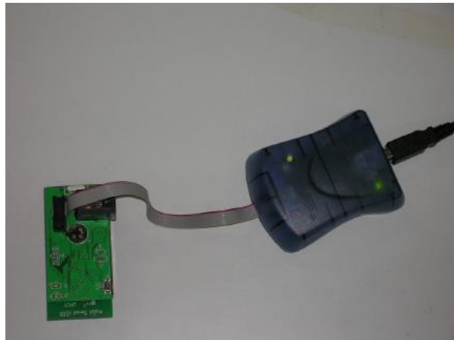
Figura 3.6: Dispositivo AVRISPmkII listo para programar un mote.
