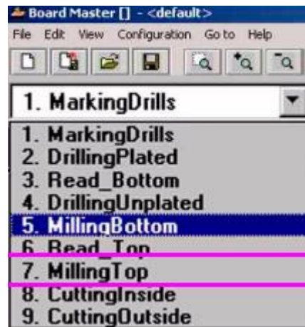
Figura 4.24: Fases de impresión del circuito
