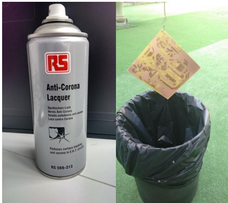
Figura 4.28: Lacado del circuito impreso
