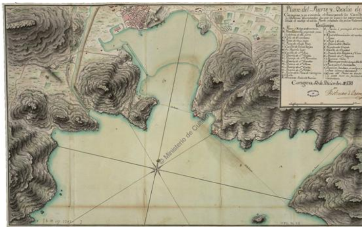
Figura 15. Plano del Puerto y Bahía de Cartagena y su cercanía demostrando los Castillos y Baterías ejecutadas, las que no lo son y las proyectadas, siendo el mollaje de dicho puerto señalados con puntos colorados. 13/12/1741. E.Panón.
