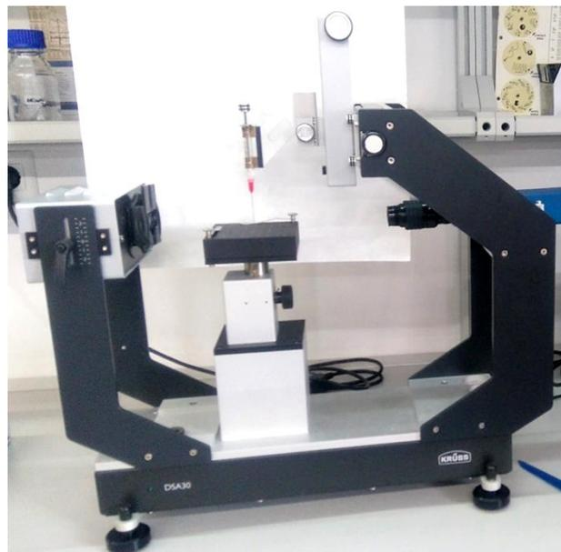
*Figura 39. Medidor de ángulo de contacto DSA.*
