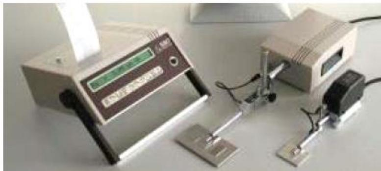
*Figura 32. Rugosímetro de laboratorio Profiltest SM-7*
