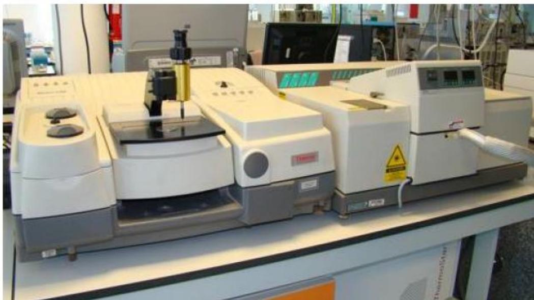
*Figura 44. Espectrofotómetro infrarrojo Thermo Nicolet 5700.*
