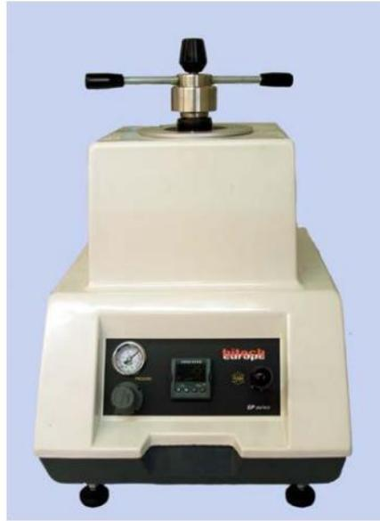
*Figura 34. Empastilladora metalográfica Hitech Europe EP15*
