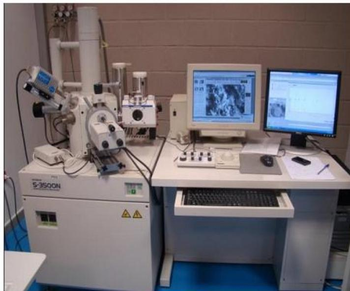
*Figura 48. Microscopio de barrido electrónico S-3500N.*
