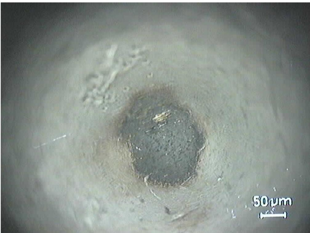
*Figura 87. Micrografía (microscopio óptico) de la huella generada en los ensayos punzón sobre disco sobre la bola de acero 316L del punzón.*
