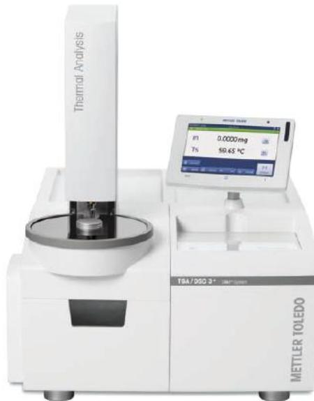
*Figura 45. Analizador termogravimétrico TGA/DSC 1HT.*
