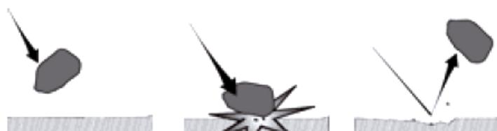
*Figura 7. Mecanismo de desgaste por erosión*
