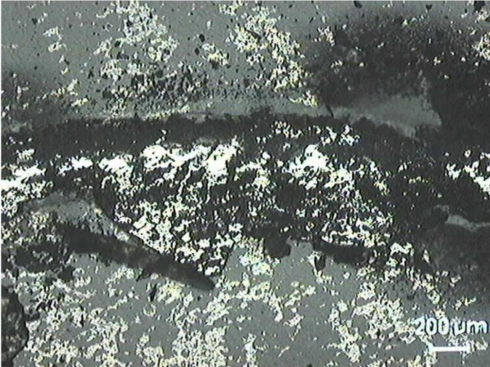
*Figura 86. Micrografía (microscopio óptico) de la huella generada en los ensayos punzón sobre disco en el recubrimiento de resina pura (1 capa).*
