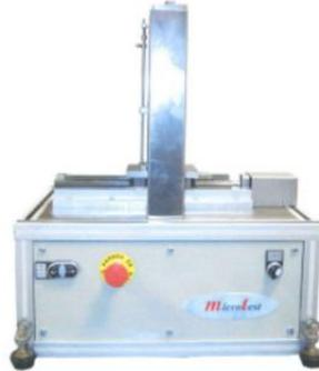
Figura 49. Rayador Scratch tester.
