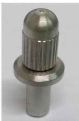
*Figura 54. Penetrador con bola de acero AISI 316L*
