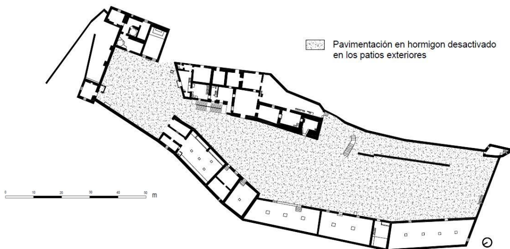
Imagen 64: Indicación de dónde se reemplazará el pavimento existente con Hormigón desactivado
