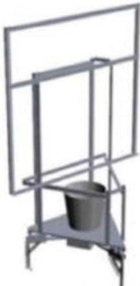
*Ilustración 15: representación del lisímetro en 3D.*
