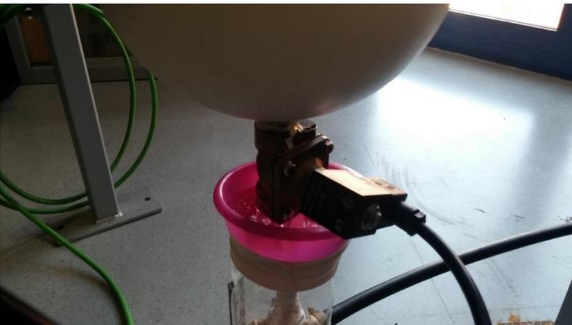
*Ilustración 25: descarga del drenaje del recipiente del lisímetro a la estructura de desagüe.*
