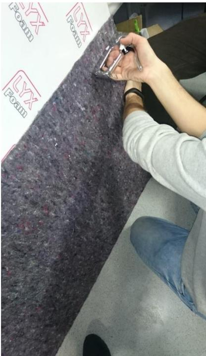
*Ilustración 19: grapado de la primera capa de manta de riego a la plancha de PVC.*
