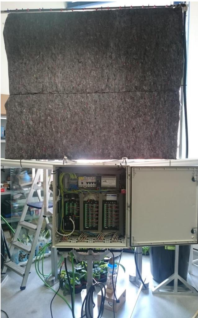
*Ilustración 21: montaje finalizado de la estructura de soporte, instalación de riego, instalación de drenaje e incorporación del cuadro donde se encuentra la central de adquisición de datos.*
