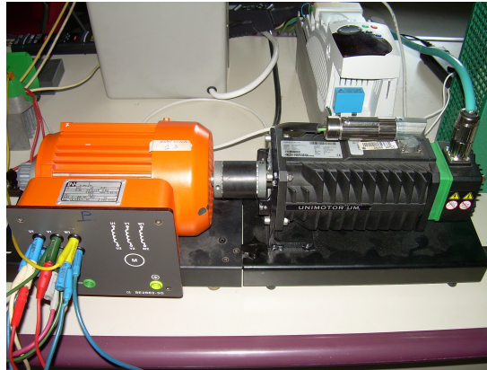
Figura 71. Detalle del acoplamiento motor asíncrono al servo
