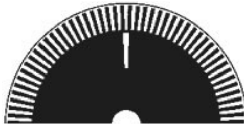
Figura 29. Disco interior de un encoder incremental
