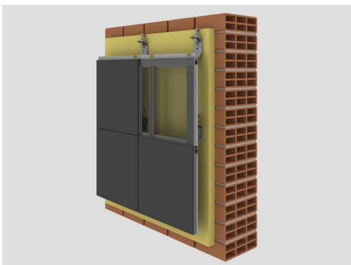
Fachada ventilada con sujeción de aplacado pétreo mediante perfilería metálica
