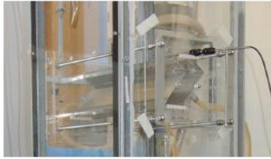
Ilustración 8: Sección de ensayo real colocada en la torre.
