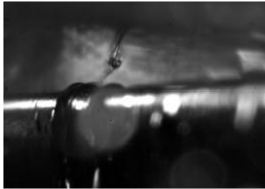
Ilustración 77: Arrastre en la salida del separador para el caudal Q2 de 4,5 L/(min·m) (VLE = 11 m/s).
