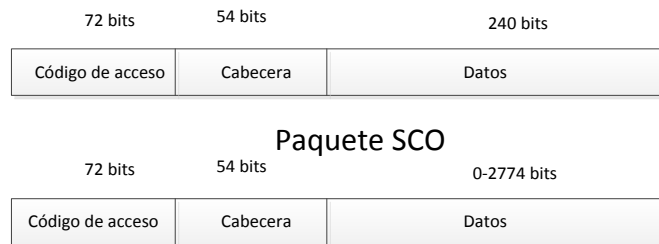
Figura 5 Formato de los paquetes SCO y ACL
