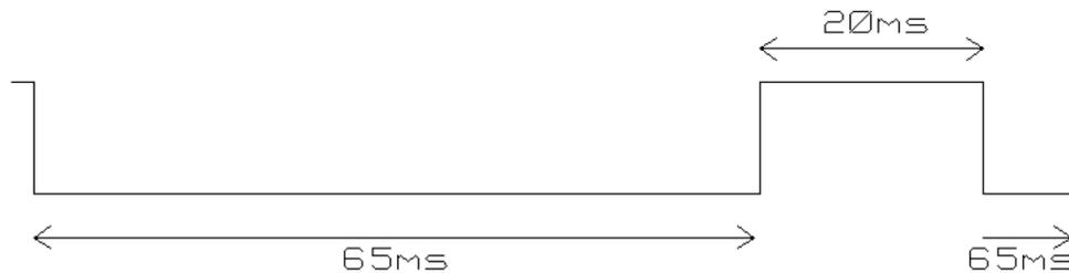
Figura 3.9. Ejemplo de señal de salida correspondiente a una lectura de 190°
