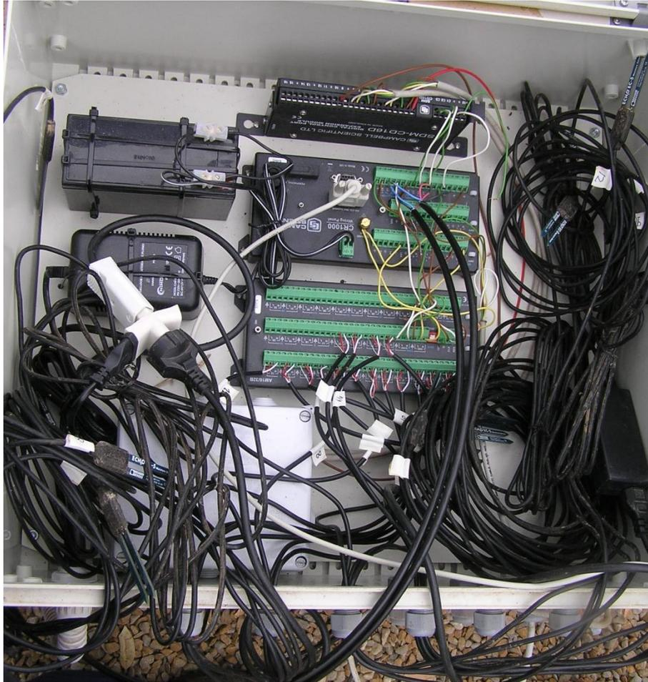
Foto 2.2.3.- Caja estanca con datalogger CR1000, multiplexor, SMD-CD16D, batería y sondas ECH<sub>2</sub>O EC-5.
