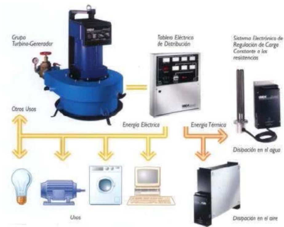
Figura 31: Diagrama de bloques del uso y conexiones de la microcentral.
