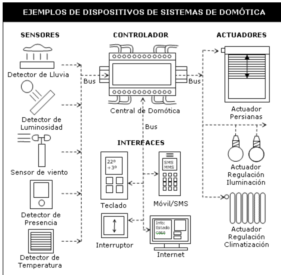
Figura 2.3. Ejemplo de componentes de un sistema domótico.
