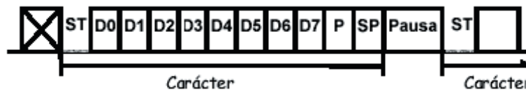
Figura 2.18. Formato de transmisión de un byte.
