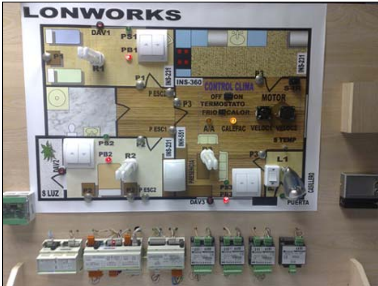
Figura 4.56. Fotografía de la maqueta con todos los dispositivos LONWORKS ya instalados.
