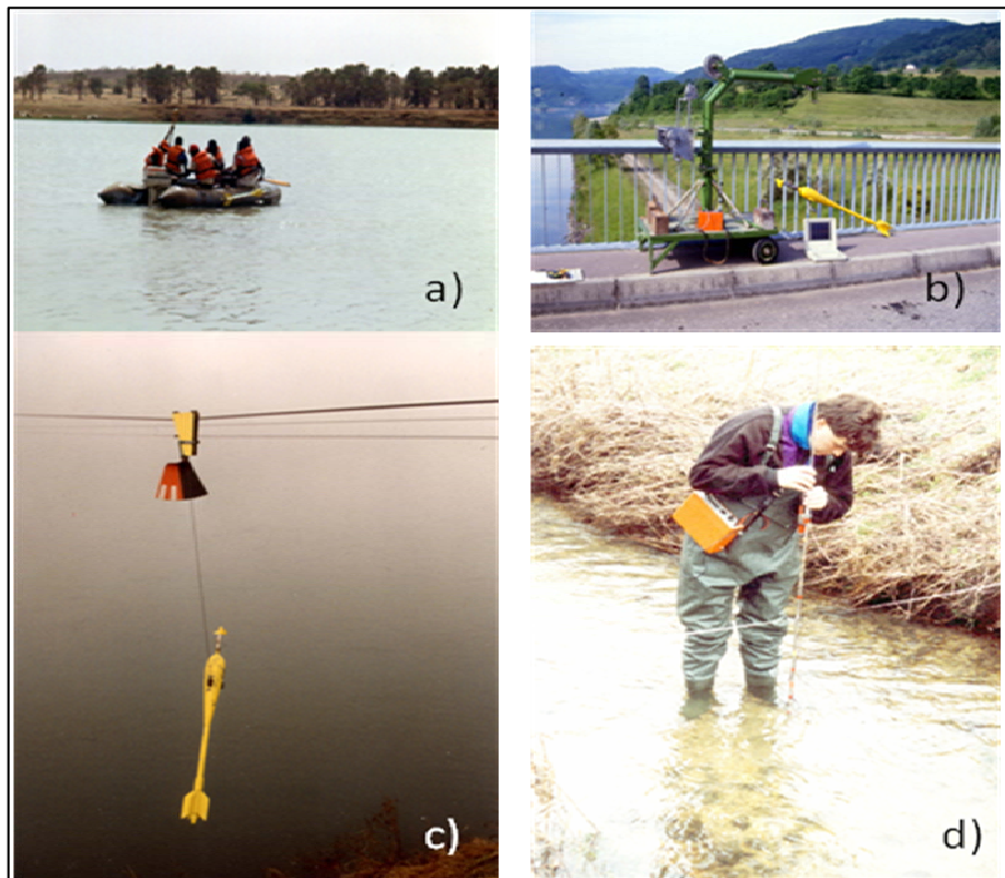
Fig. 22. Distintos modos de emplazar el molinete para realizar el aforo. Tomada de http://www.cig.ensmp.fr/ .
