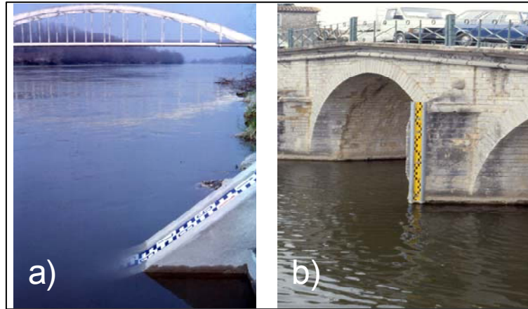
Fig. 12. a) Mira inclinada. Tomada de www.cig.ensmp.fr/ . b) Mira en el pilar de un puente. Tomado de www.cig.ensmp.fr/ .
