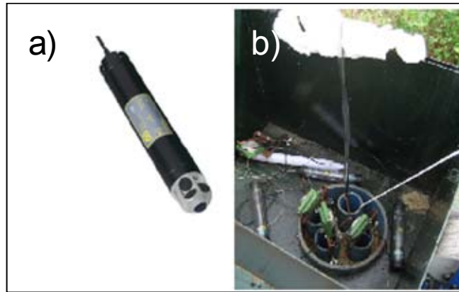
Fig. 60. a) Sensor piezométrico de presión hidrostática con data logger incorporado. b) Sondeo multitubo con cuatro piezómetros equipados con sensores de presión. Fotos de M. Manzano.
